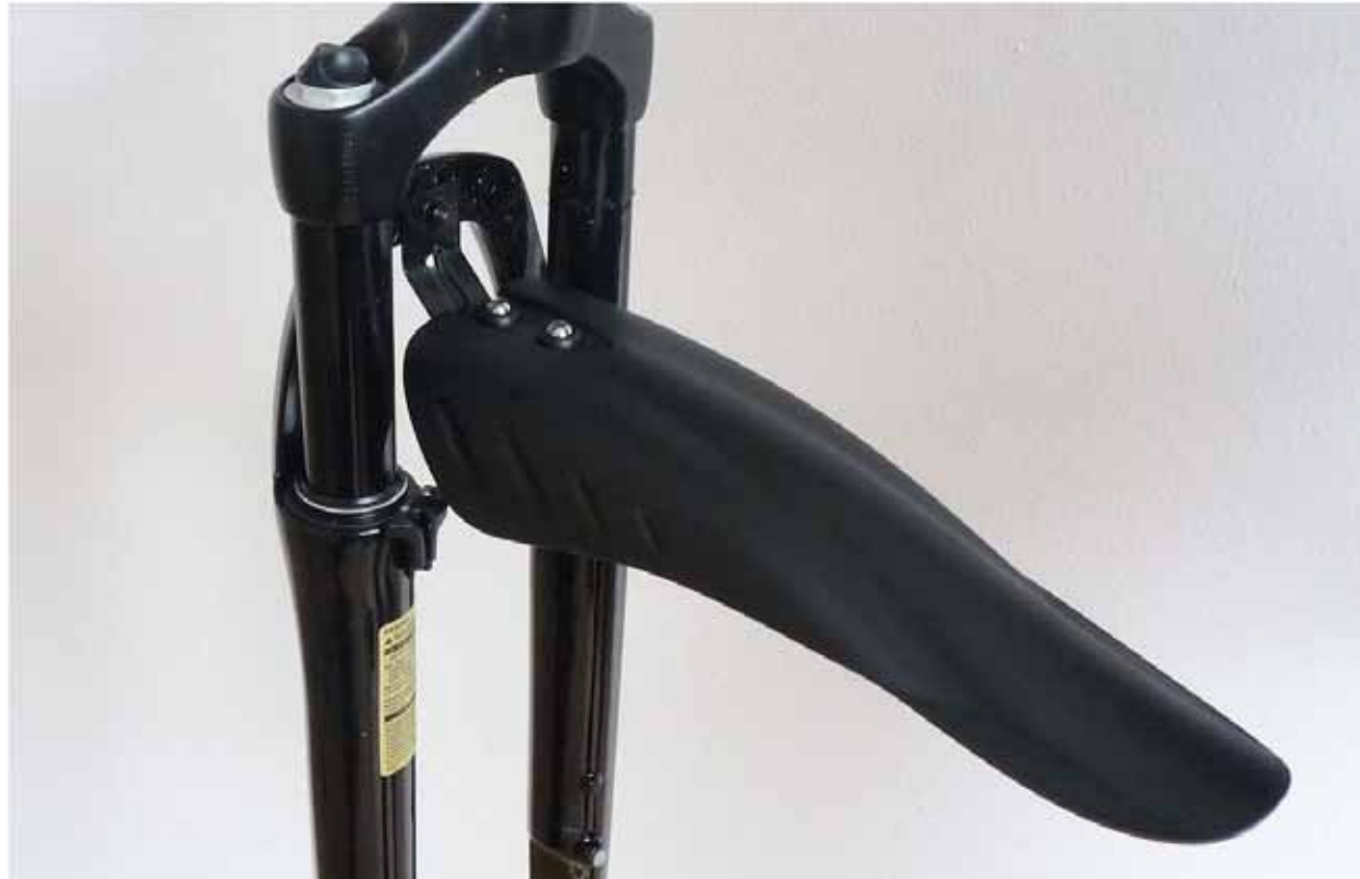
Abbildung 15: Befestigung Schutzblech an der Gabel
