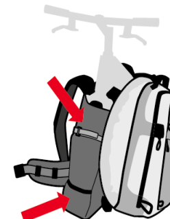
10D: Falls sie ein Modell mit abnehmbaren Vorbau besitzen können sie den Lenker abnehmen und in der Seitentasche verstauen und sichern.
