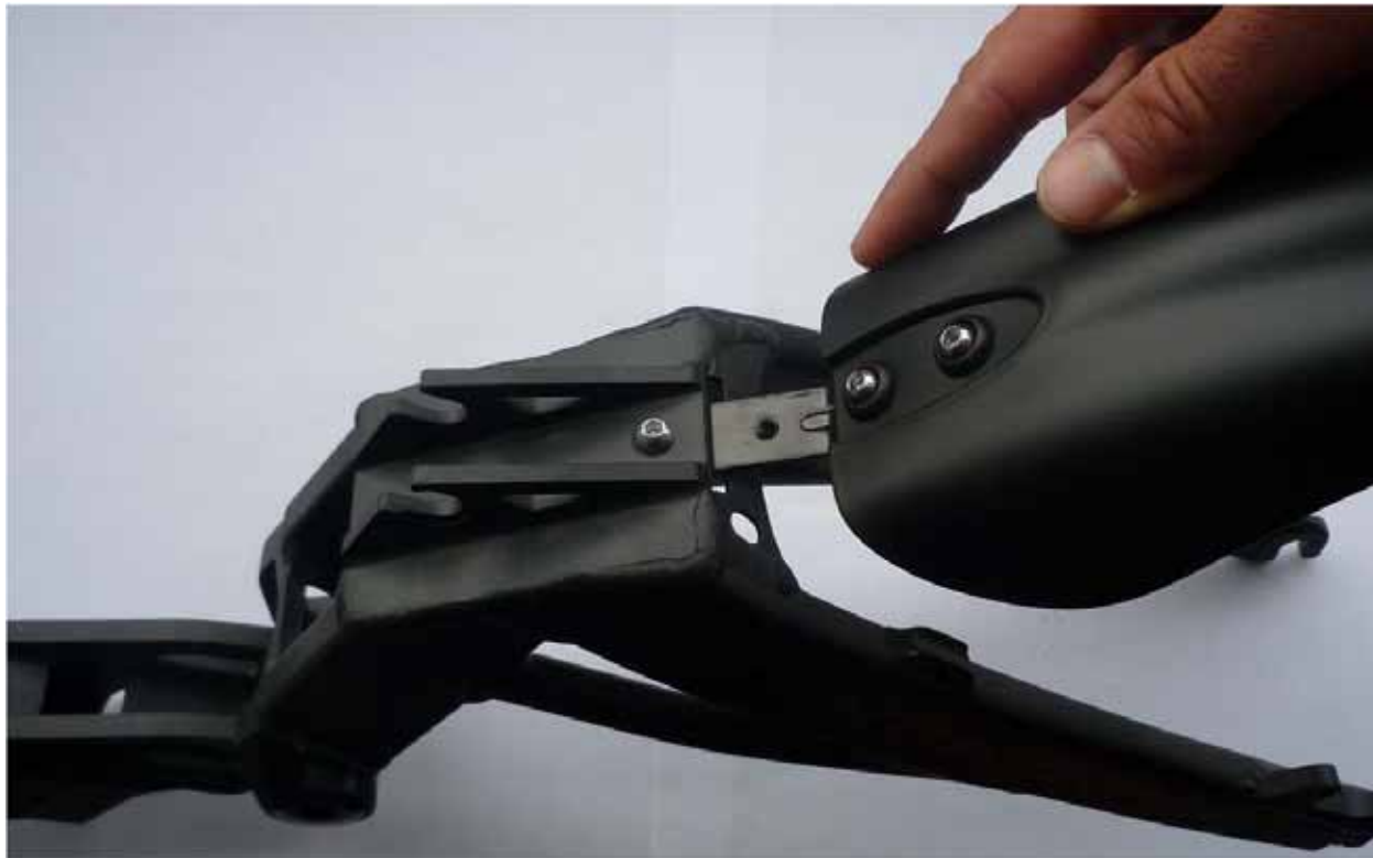
Abbildung 14: Befestigung Schutzblech an der Hinterbauschwinge
